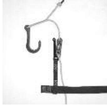
9. Nouer le nœud d'extrémité débrayable à l'extrémité de la corde et fixer les étiquettes appropriées. Consulter la section « *Remplacement du nœud d'extrémité débrayable à l'extrémité de la corde* » de ce manuel.
