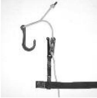
6. Nouer le nœud d'extrémité débrayable à l'extrémité de la corde et fixer les étiquettes appropriées. Consulter la section « *Remplacement du nœud d'extrémité débrayable à l'extrémité de la corde* » de ce manuel.
