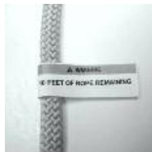
5. Vérifier que le nœud d'extrémité débrayable est bien présent à l'extrémité de la corde et que toutes les étiquettes sont en place.
